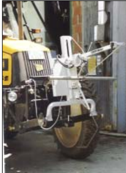
Abb. 78: Betriebsbereiter Pendelsensor „Cropmeter“
