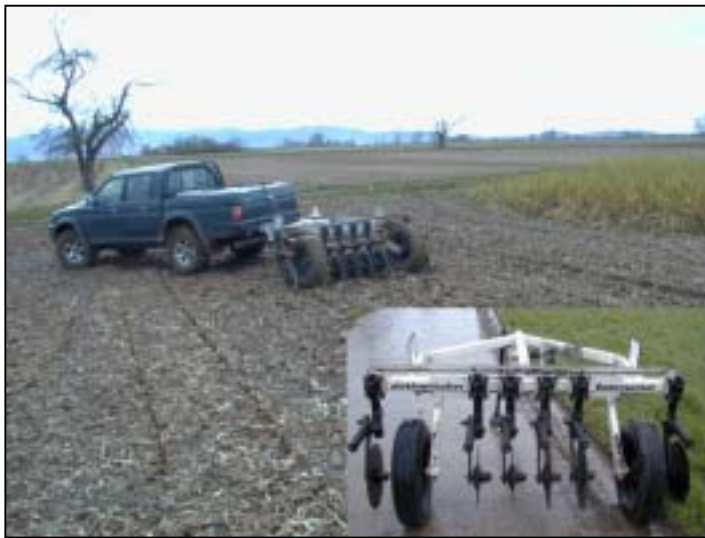
Abb. 34: GPS-gestützte Messung der elektrischen Bodenleitfähigkeit mit „Veris 3100“
