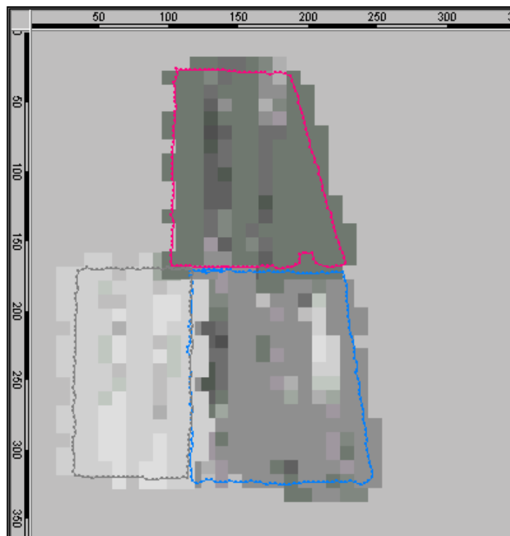
Abb. 52: Maschinenlesbare Applikationskarte für die Modulation von Harnstoff unter Berücksichtigung der Versuchsanordnung. (Pixelgröße 10 m, ein heller Wert bedeutet eine geringe, ein dunkler Wert eine intensive Applikation)
