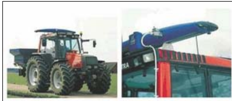
Abb. 1: Hydro-N-Sensor als Anbaugerät
