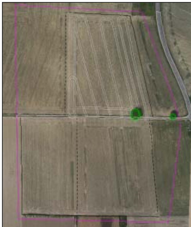
Abb. 86: Georeferenziertes, mit Einfachverfahren entzerrtes Luftbild; Aufnahme mit Motordrachen vom 10.06.2004, 3 Tage nach Düngung bei kniehohem Mais im 7 Blatt-Stadium; Referenzpunkte aus der Stereomessung zuvor
