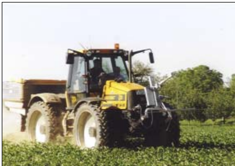
Abb. 131: Teilflächenspezifische Düngeapplikation am 07. Juni 2004; An der angehobenen Fronthydraulik ist der hier nicht verwendete Pendelsensor zu sehen
