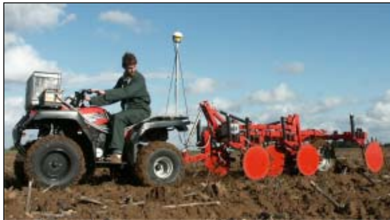
Abb. 9: Messung der elektrischen Leitfähigkeit unter Verwendung eines ARP-Gerätes (Entwicklung durch CNRS) am QUAD
