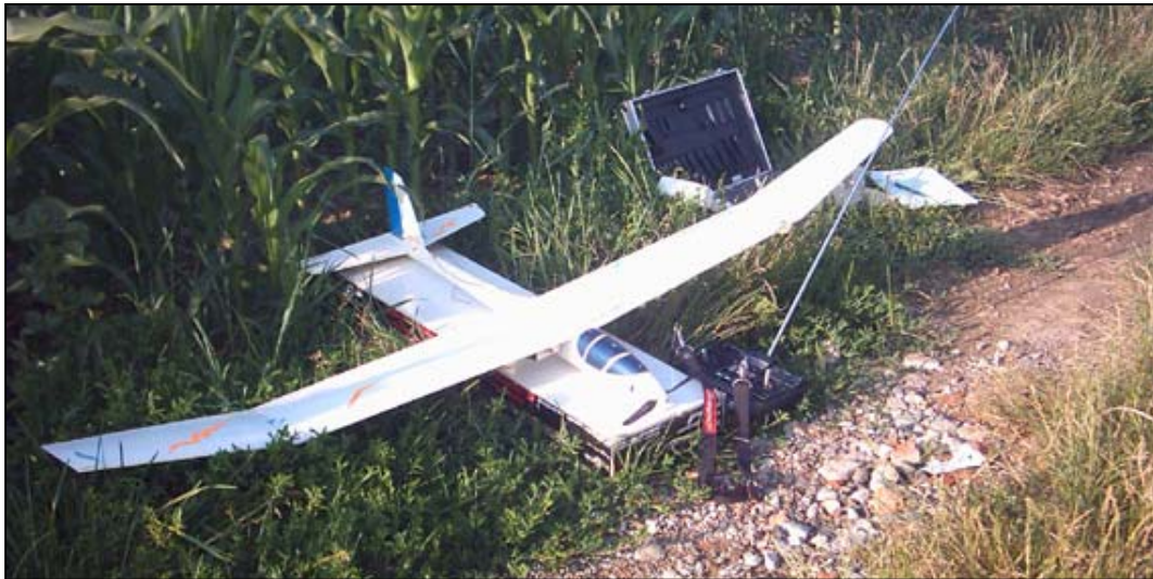
Abb. 83: Für die Luftbildaufnahmen verwendeter ferngesteuerter RC-Motorsegler
