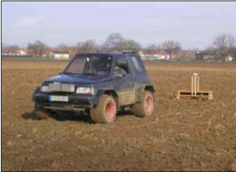
Abb. 36: GPS-gestützte Messung der elektromagnetischen Leitfähigkeit mit „EM 38“
