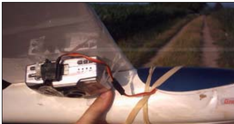
Abb. 84: Befestigung und Auslösung am Beispiel der APS Kamera direkt an der Schwerpunktlage und in Rumpfnähe
