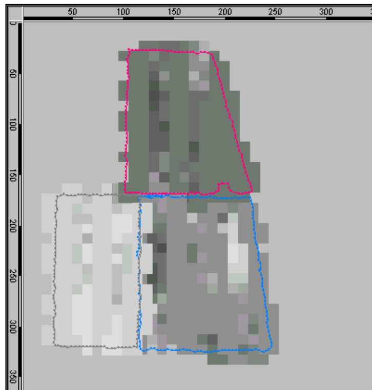
Fig. 52 : carte d'application praticable avec l'outil d'épandage pour la modulation des apports d'urée en considération du dispositif de l'essai. (taille pixel = 10m, une valeur claire signifie un apport faible, une valeur sombre un apport important)
