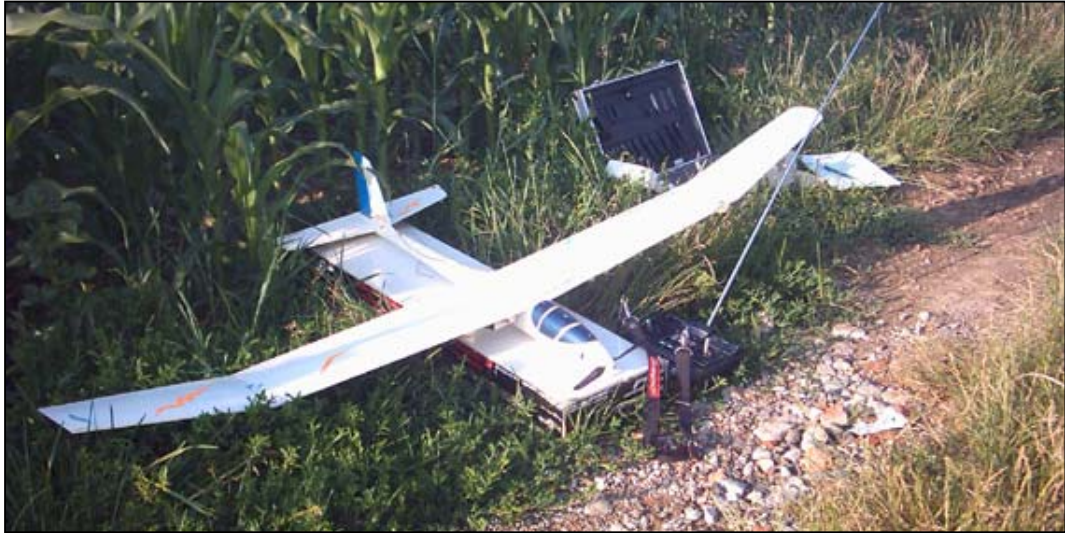
Fig. 83 : le planeur motorisé télécommandé utilisé pour les prises de vue
