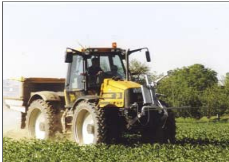
Fig. 131 : application d'engrais au niveau intraparcellaire du 7 juin 2004 ; on distingue le capteur pendulaire (non utilisé ici) à l'avant du tracteur
