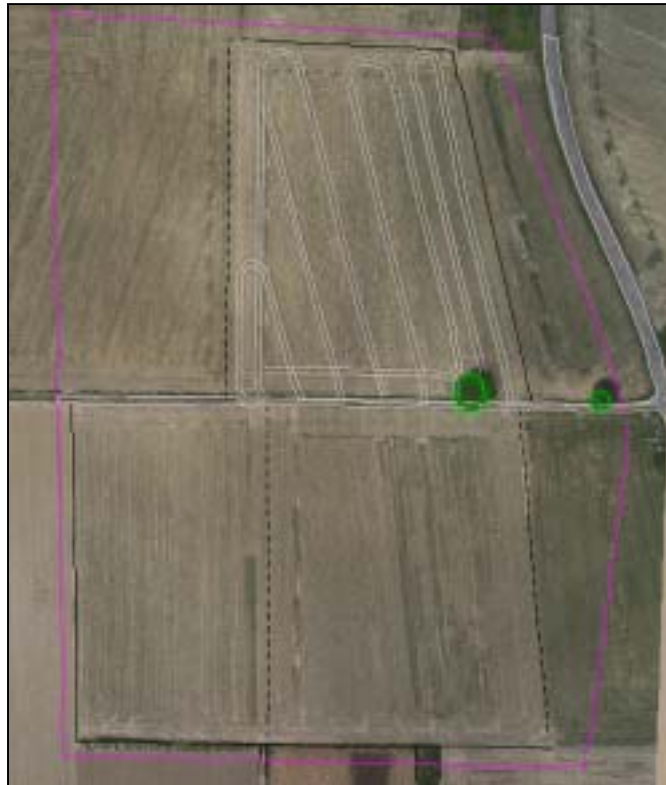
Fig. 86 : image aérienne géoréférencée corrigée par une méthode simple ; prise de vue du 10 juin 2004 avec l'ULM, trois jours après une fertilisation du maïs au stade 7 feuilles (hauteur de genou) ; points de références issus des mesures stéréoscopiques effectuées précédemment
