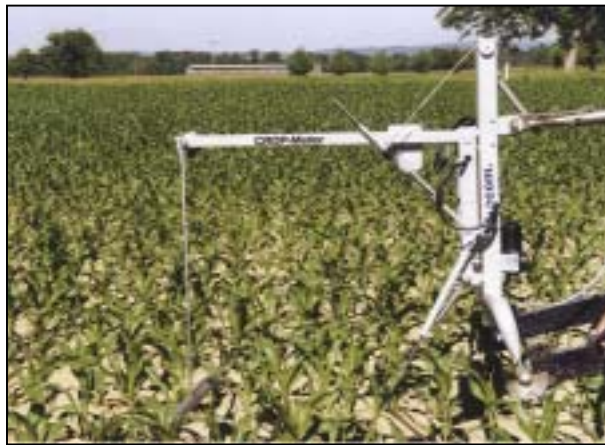
Fig. 143 : capteur pendulaire modifié dans le maïs à hauteur de genou (stade 7 feuilles)
