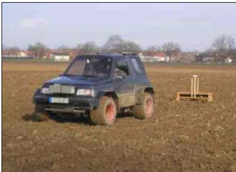
Fig. 36 : mesure de la conductivité électrique avec „EM 38“
