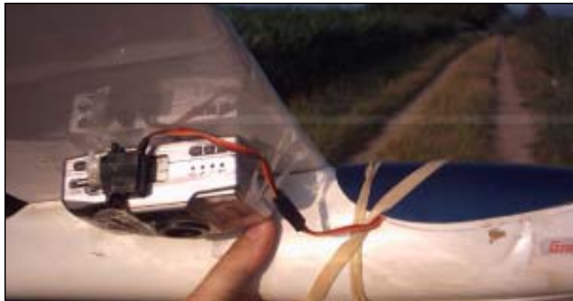
Fig. 84 : à titre d'exemple, mode de fixation et de déclenchement de l'appareil APS directement fixé sur le centre de gravité et sur le fuselage du planeur
