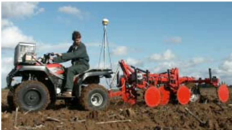
Fig. 9 : mesure de la résistivité électrique avec un quad équipé d'un matériel ARP
