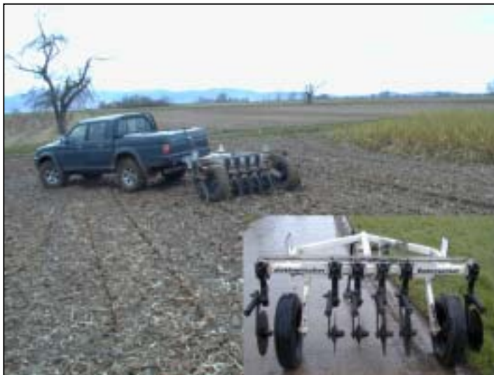
Fig. 34 : mesure de la conductivité électrique enregistrée avec GPS avec „Veris 3100“
