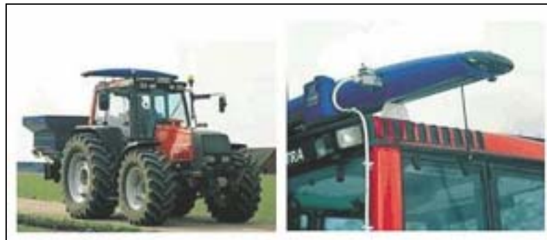
Fig. 1 : Hydro-N-Sensor : un outil pour la conduite culturale
