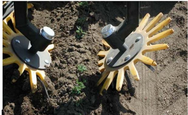
Photo 1 : utilisation de la bineuse à doigts Kress sur lupin (cf. Chap 3.3.2.2. )
