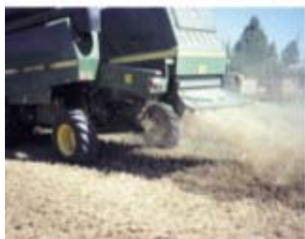
Fig. 10. Il est avantageux de disposer d'un moulinet-rouleau pourvue de répartiteurs aussi bien pour les balles que pour la paille. Les résidus de récolte sont ainsi bien répartis et ne forment pas d'andains gênant la germination.
