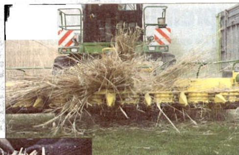
Une ensilève classique peut récolter le miscanthus à partir de la deuxième année, de fin février à la mi-avril. Elle doit être équipée d'un bec rotatif de type Kemper.
