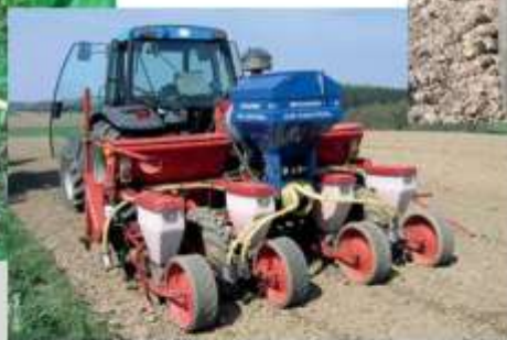
Éléments semeur Air Control Hatzenbichler
