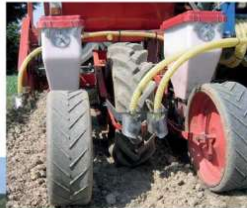
Éléments semeur Air Control Hatzenbichler
