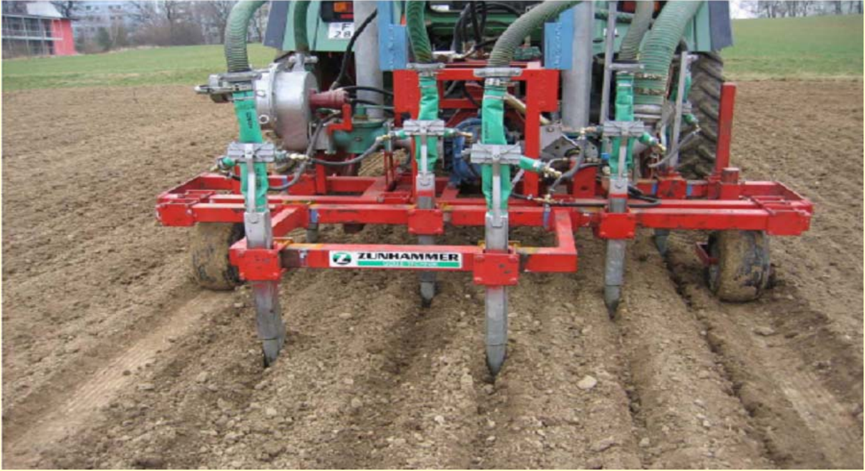
Gülle-/Gärrestinjektion (10 cm tief) – Maissaat zwischen die Güllebänder
