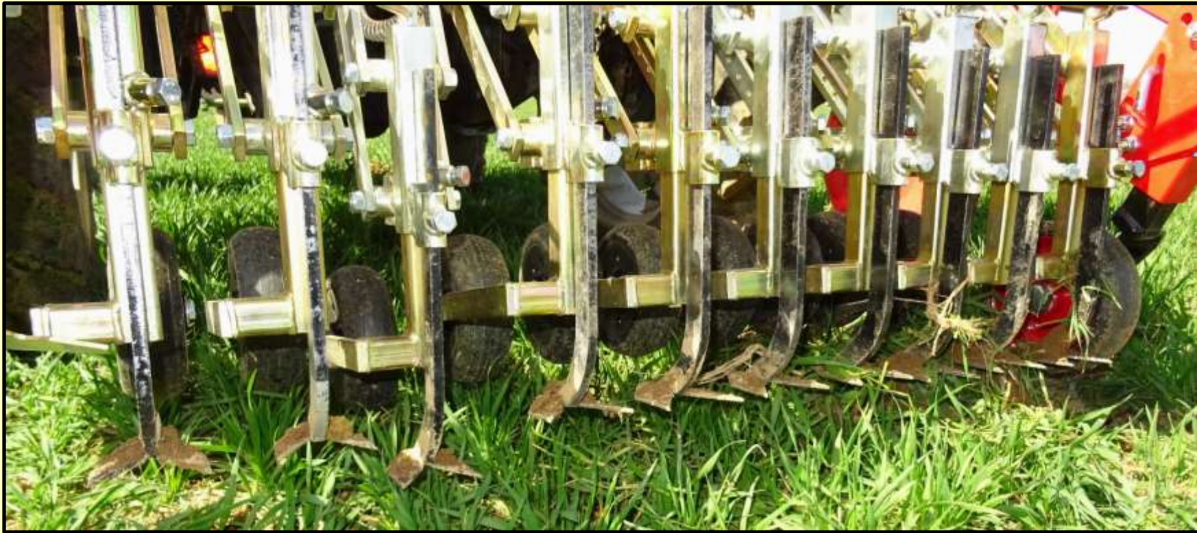
Description du bâti utilisé et des socs de binage à plat.
